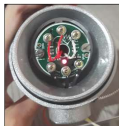
Figura 2 - PT100 e suas conexões
