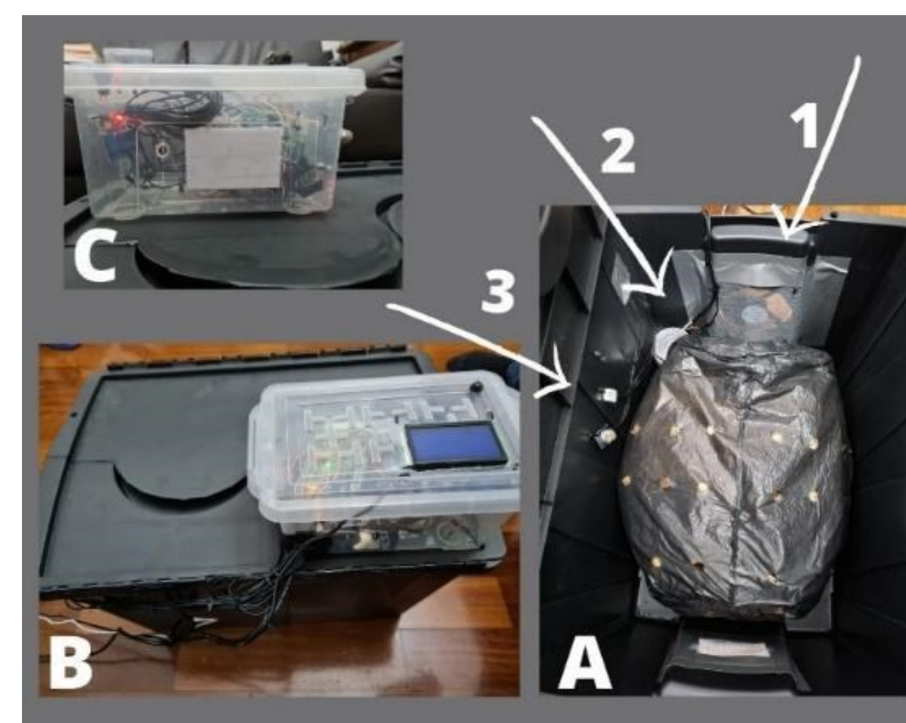
Figura 2. Imagem do protótipo em teste. Em (A) está o interior da caixa plástica com a ventoinha (1) para controle de saída de ar, com o umidificador (2) e os sensores (3) de temperatura, umidade e CO 2 . Em (B) a parte externa da caixa com as instalações elétricas e em (C) o destaque para o local com a fiação, e o arduino.
