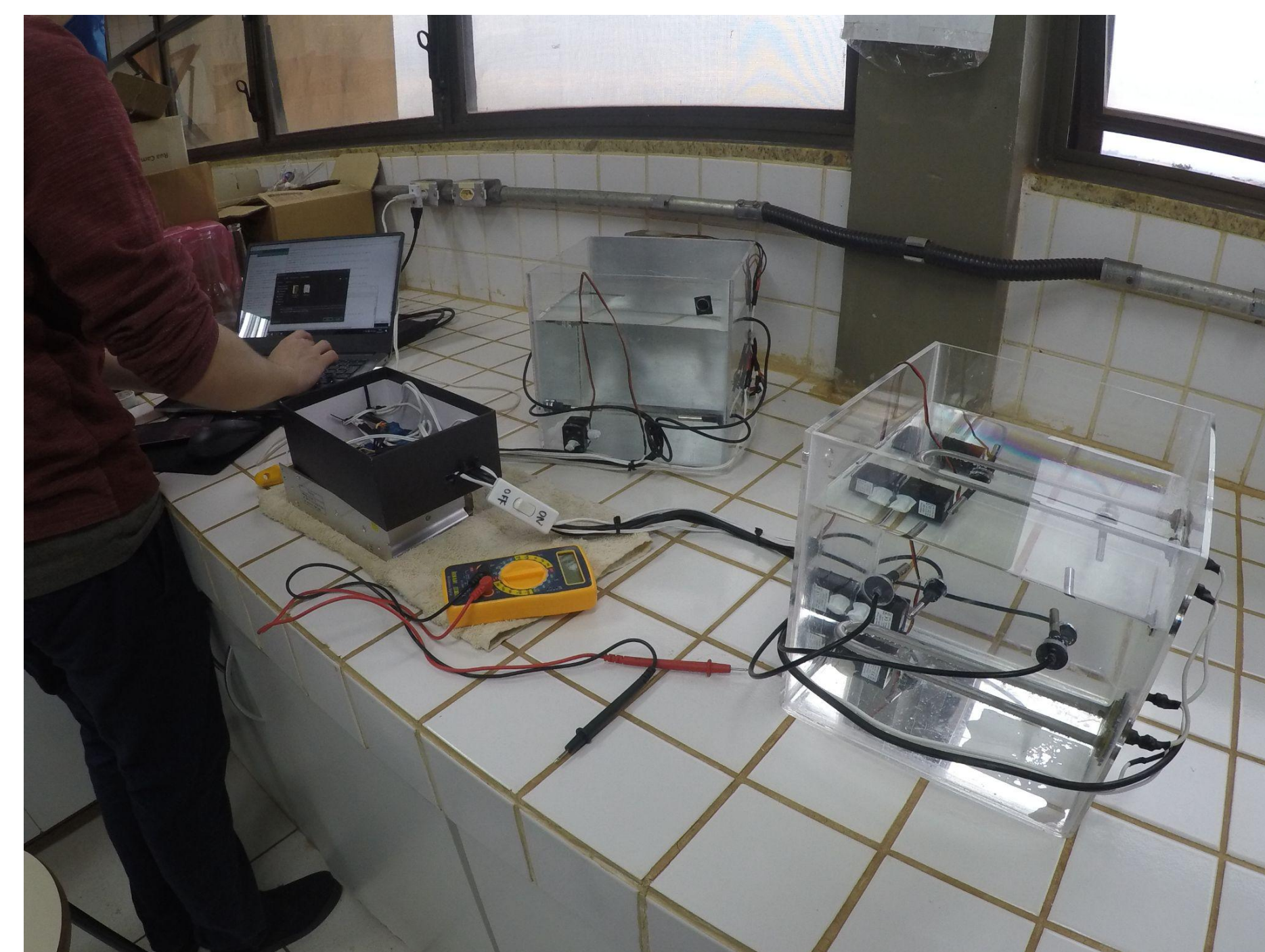
Figura 1 - Fotografia do sistema com os dois reservatórios, sensores, resistências e bombas instaladas em teste.
